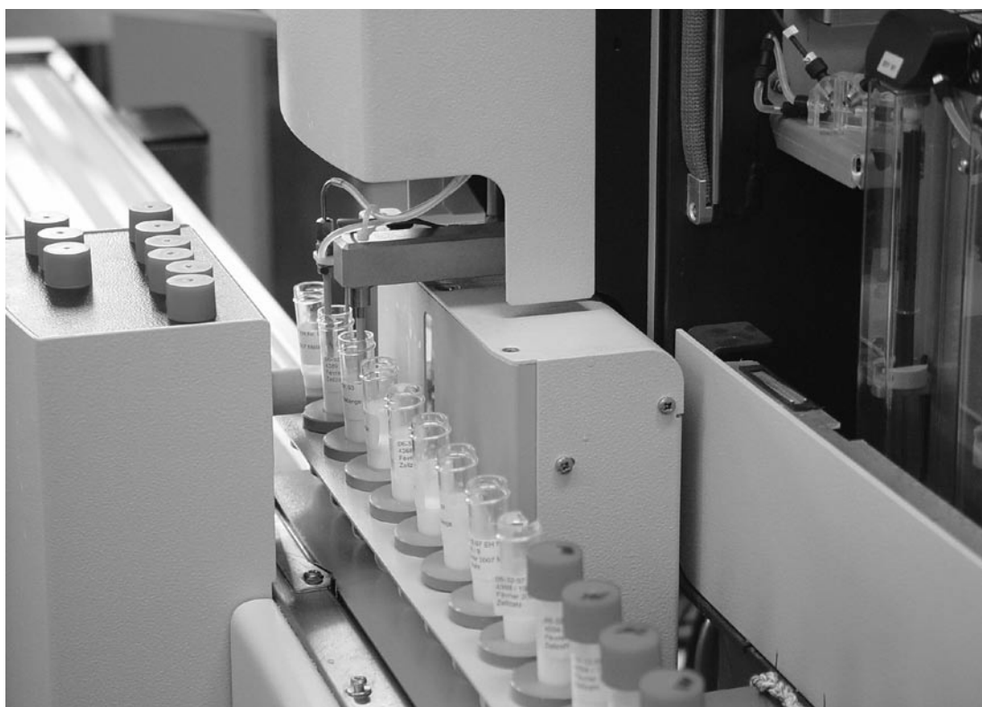
Abb. 3. Die Zellzahl ist ein gutes Merkmal um Euterentzündungen beziehungsweise Euterinfektionen zu erkennen. (Zellzahlbestimmung im Labor mit einem Fossomaticgerät)
